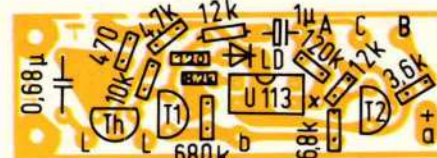
Fig. 3. Zo worden de onderdelen op de print bevestigd.
