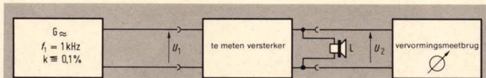
Fig. 1. Zo wordt de vervorming gemeten. In plaats van een luidspreker wordt een belastingsweerstand aangesloten, als het tenminste alleen om de versterker gaat.
